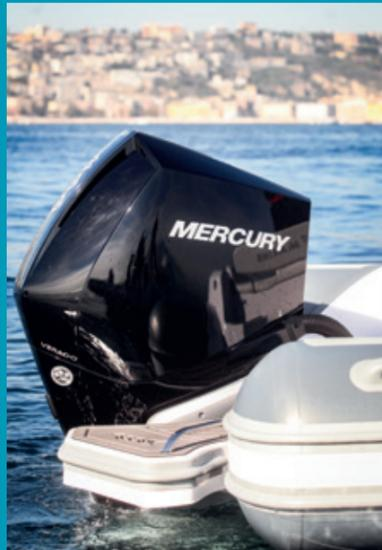
Il fuoribordo *Mercury Verado V8* è un otto cilindri DOHC aspirato con doppia coppia di camme 24 valvole e 4571,99 cc. Questo motore è dotato di un rapporto di riduzione più corto 1:85 diversamente dall' 1:75 del suo predecessore V6. Questo consente l'utilizzo di eliche di diametro maggiore che forniscono una maggiore spinta a medi e bassi regimi.
